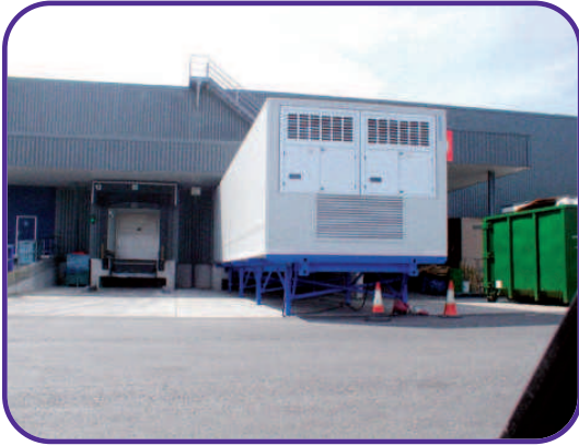
CHASSIS DE MISE A QUAI
